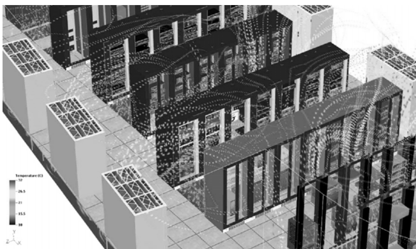
Рис.4. Измерение тепловых потоков от работающих электроустановок
