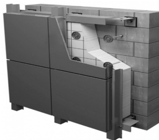
Рисунок 1. Устройство НВФ с применением утеплителя.
